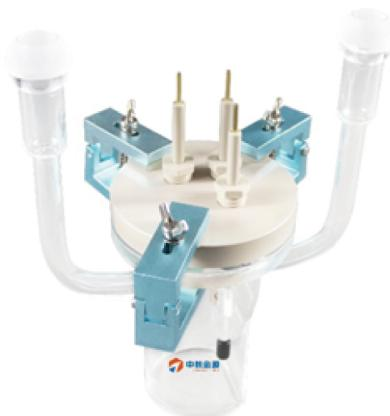
CEL-QPR150侧照全石英反应器，采用熔接技术一体成型，侧照使光直接接触反应溶液，提高了光的使用效率，通光均采用紫外高透石英，法兰密封配置了PEEK、不锈钢、石英玻璃反应器盖，保证了反应器的密封，实现了一个反应器在光电催化、光催化、催化、气固、气液、液固、非均相反应中的多种应用。可以根据需求定制不同的电极通道、配进气和出气孔；可实现真空与惰性气体保护。
